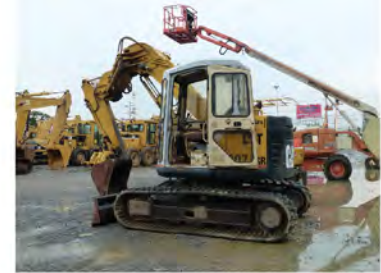
รถขุด307SSR บูมพับ 54 แรงม้า บุงกี้ 0.3 ลบ.ม.
