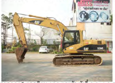
รถชุด320C ยอดนิยม 138 แรงม้า บุงกี 0.9-1.0 ลบ.ม.
