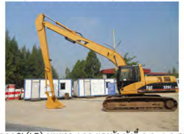
รถชุด320CL(LR) บูมยาว 138 แรงม้า บุงกี 0.9-1.0 ลบ.ม.
