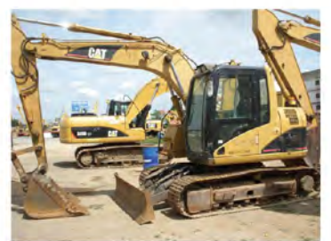
รถชุด311CU ท้ายสั้น 82 แรงม้า บุงกี 0.5 ลบ.ม.
