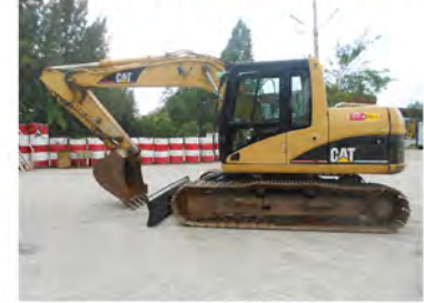
รถขุด312CL เปลี่ยนบูมยาวได้ 90 แรงม้า บุงกี้ 0.45 ลบ.ม.
