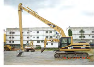
รถขุด320BL(LR) บูมยาว 128 แรงม้า บุงกี้ 0.9-1.0 ลบ.ม.
